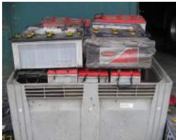
Figura 17. Observación en terreno: almacenamiento de baterías de ácido plomo en desuso en bins dentro del taller mecánico.
