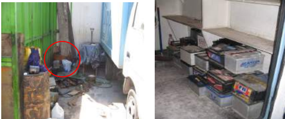
Figura 16. Observación en terreno: almacenamiento de baterías de ácido plomo en desuso en cualquier rincón del taller mecánico.
